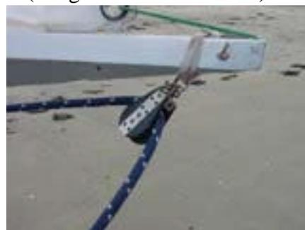
Un aberrant système de tire sur le pont ( inadapté à la coupe du foc ) ne semble donner qu'un rendement minimum au foc. Je récupère les ensembles poulies-rails et les fixe sur le fond. Le point de tire devient alors réglable en hauteur et en latéral rattrapé par un sandow.
