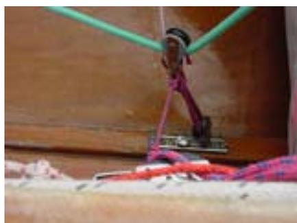
L'écartement de 250 mm de l'axe du bateau peut être ainsi respecté. La poulie volante devient réglable en hauteur et permet de placer l'écoute en continuité de l'angle de tire ; tracé sur le foc suivant les indications du voilier. ( je rêve du système rigide mais n'est pas fait le pas pour l'instant...)
